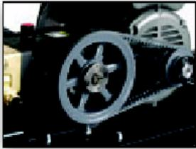
■ Moteur qualité industrielle et bagues de poulies en fonte utilisant un ajustement commode de poulie à deux écrous pour un entretien facile et une durée de vie plus longue; une courroie en forme de 'V' dentée connecte le moteur à la pompe haute pression de Landa, dotée de trois pistons céramiques, d'une tête en laiton forgé et un concept unique résultant en plus bas RPM que les pompes comparables pour moins d'entretien et une durée plus longue. Garantie 7 ans.
