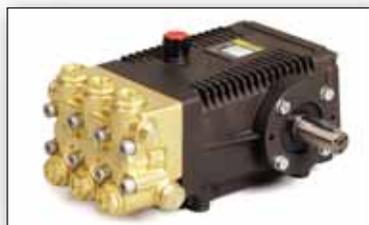
• La robuste pompe haute-pression Landa à trois pistons en céramique, avec tête en laiton forgé et garantie de 7 ans, est connectée au moteur par un système de poulies en fonte et de deux courroies avec encoche en « V », se qui réduit l'accumulation de chaleur et l'usure prématuré. Aussi, la tension de la poulie est facilement ajustée avec seulement deux boulons.
