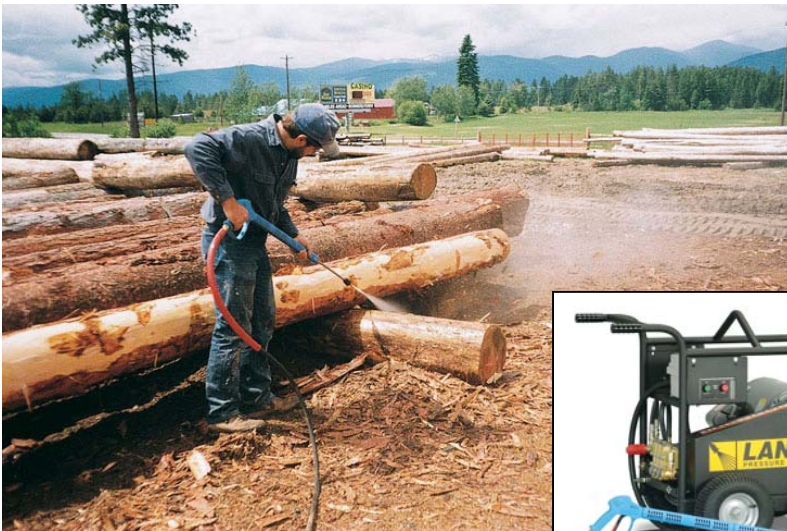
Arracher l'écorce des rondins est une des applications pour les laveuses haute pression MP ou MPE avec un pouvoir nettoyant jusqu'à 5000 PSI.
